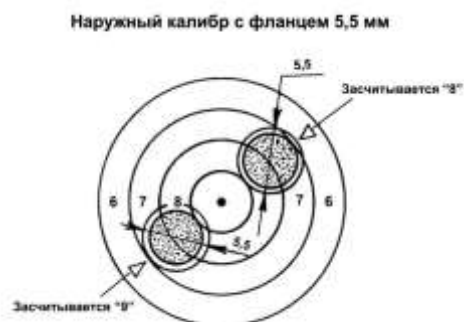
Рис. 2. Применение наружного калибра для определения достоинства пробоины в стрельбе из пневматической винтовки.
